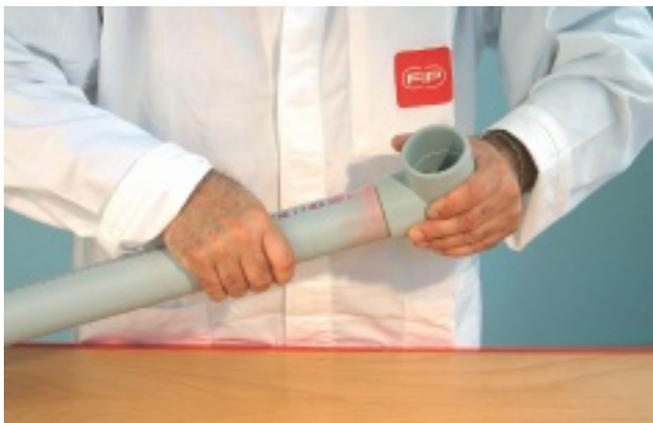
7. Удалите лишний клей с внешней поверхности соединения.
